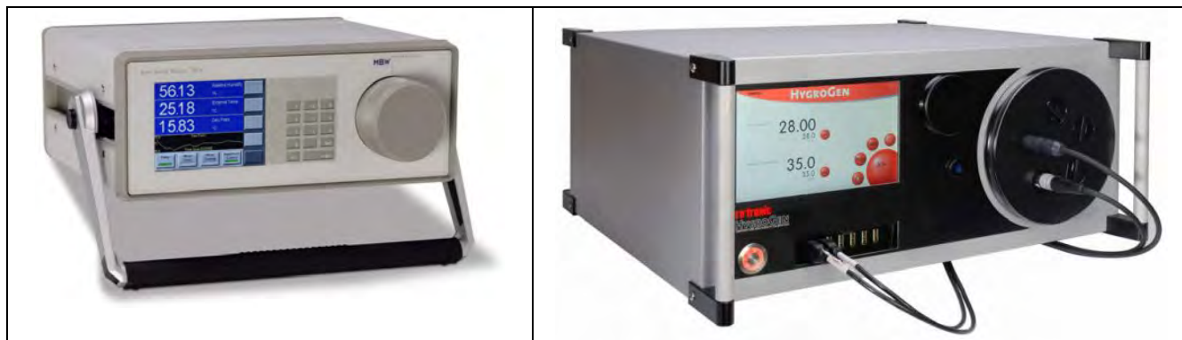
Рисунок 4. Внешний вид генератора влажного воздуха HygroGen модификации HygroGen 2-973. Слева показан блок внешнего контрольного конденсационного гигрометра, справа показан блок воспроизведения и поддержания влажности.
